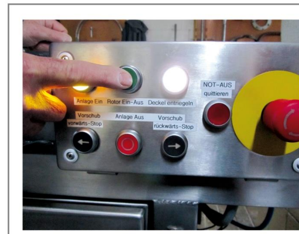
Press "Rotor ON-OFF"
